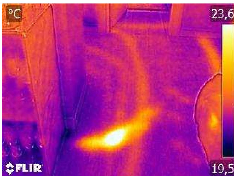
Esempio di ricerca ed individuazione della perdita di un impianto termico sottotraccia in un immobile per civile abitazione senza eseguire sondaggi invasivi.
