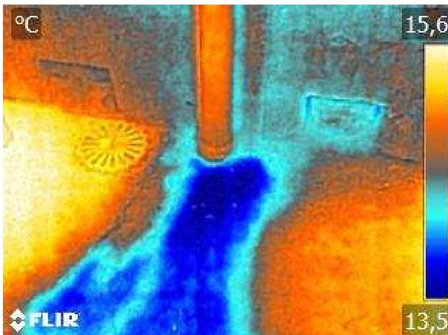
Esempio di ricerca ed individuazione della provenienza di una perdita/infiltrazione di acqua senza eseguire sondaggi invasivi.
